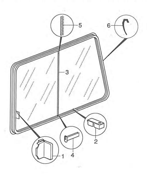
01 0319900 FENSTER-GUMMIRAHMEN 900X450 02 0317820 FENSTER-GUMMIRAHMEN EINREISSFUELLER
