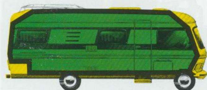
Knautschzonen im Front- und Heckbereich des Hytermobils.
