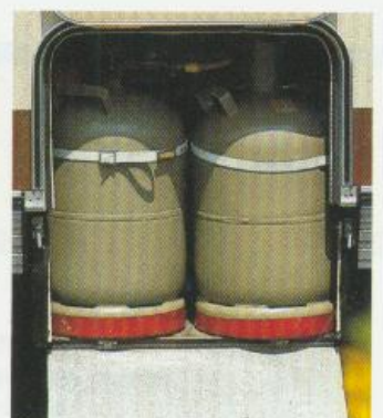
Integrierter Gasflaschenkasten für die Aufnahme von 2x11 kg Gasflaschen, nach innen vollkommen gasdicht.
