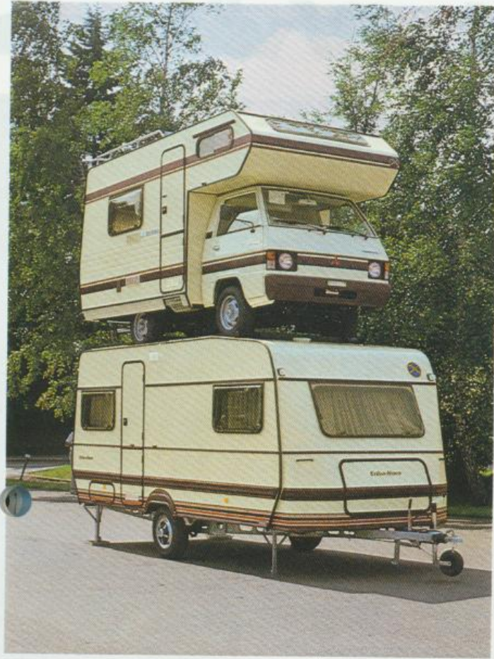
Die 1720 kg des Hymercamp 45 auf dem Dach des Nova beweisen die stahlharte PUAL-Stabilität.
