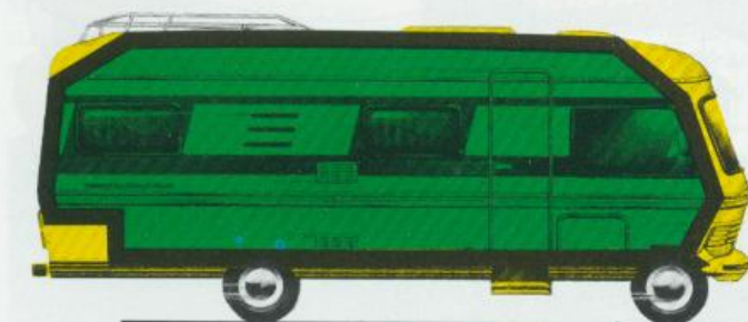
Knautschzonen im Front- und Heckbereich des Hytermobils.
