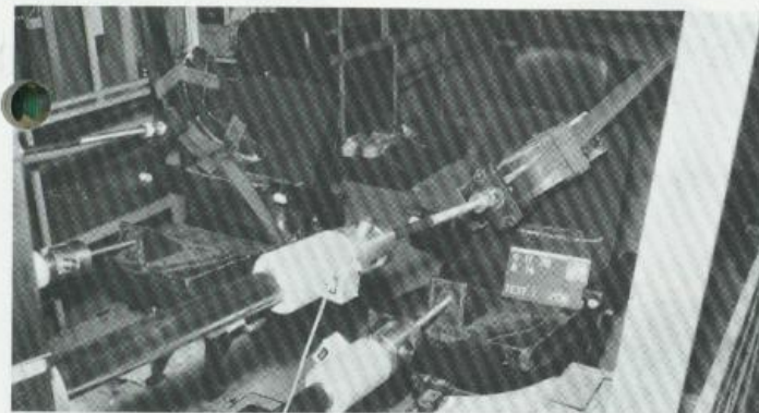
Gurtbefestigungspunkte nach ECE 14 geprüft.
