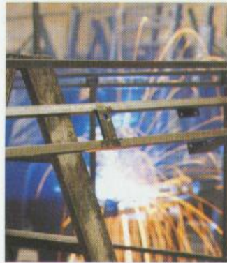
Geschweißter Stahlrohrrahmenteil des Hymermobils.
