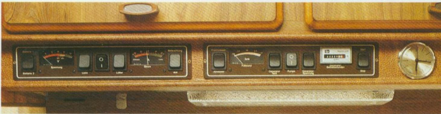
Check-Control-Panel in Verbindung mit CL-Paket im Hymermobil 650, 660, 665, 750.
