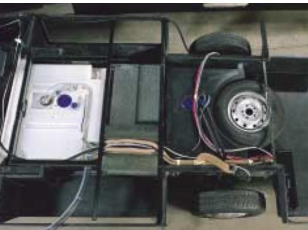
Fortschrittliche Innovation und richtungsweisende Technologie verkörpern am augenscheinlichsten das HYMER-Doppelboden-Konzept bei den Hymercamp GT- und Hytermobil B-Klasse-Modellen. Dieses System basiert auf einem Spezial-AL-KO-Tiefrahmen-Chassis mit einem isolierten und beheizten Unterflurstauraum.
