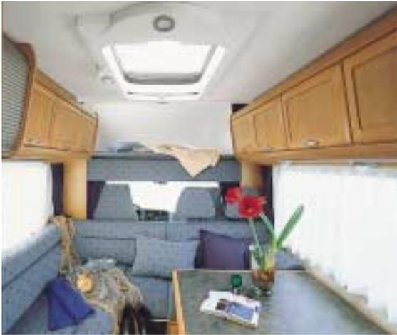
Kennzeichen dieser beiden Modellreihen ist u. a. der große HYMER-Kurbeldachlüfter, der isolierverglast und mit einem Moskitoverdunklungsrollo sowie Beleuchtung ausgestattet ist. Die klare Trennung von Fahrerhaus und Alkoven zum Wohnraum wird durch einen blickdichten Vorhang unterstützt.
