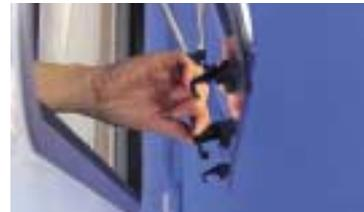
Fensterrahmen sind bündig in die Seitenwand eingelassen (nicht bei B-Classic, Camp und Tramp) und bieten in Verbindung mit den glattflächigen Aluminiumschürzen an der Seitenunterkante eine weitere Optimierung der Aerodynamik.
