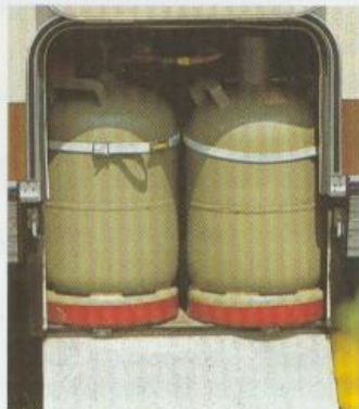
Integrierter Gasflaschenkasten für die Aufnahme von 2 x 11 kg Gasflaschen, nach innen vollkommen gasdicht.
