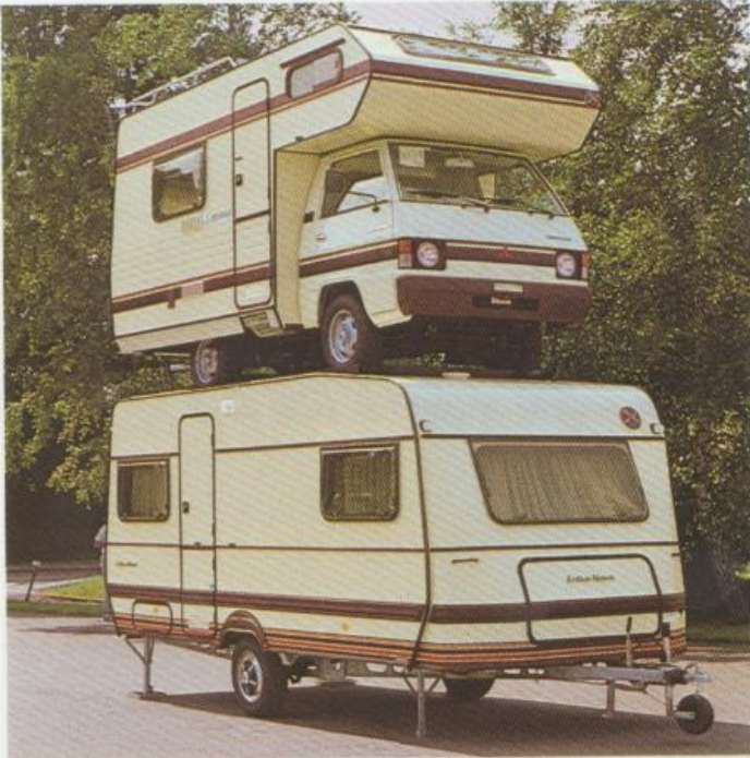
Die 1720 kg des Hymercamp 45 auf dem Dach des Nova beweisen die stahlharte PUAL-Stabilität.
